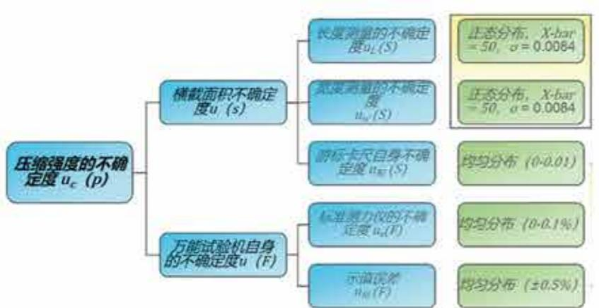
使用统计软件模拟仿真，将输入变异输入测量模型计算得到在规格100 Lbs/in^2输出变异（如下图）。
